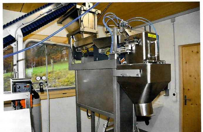
Der letzte Schritt bei der Verarbeitung der Baumnuße ist die Verpackung, wo die Nusskerne verpackt und vakuumiert lagerfähig gemacht werden.
