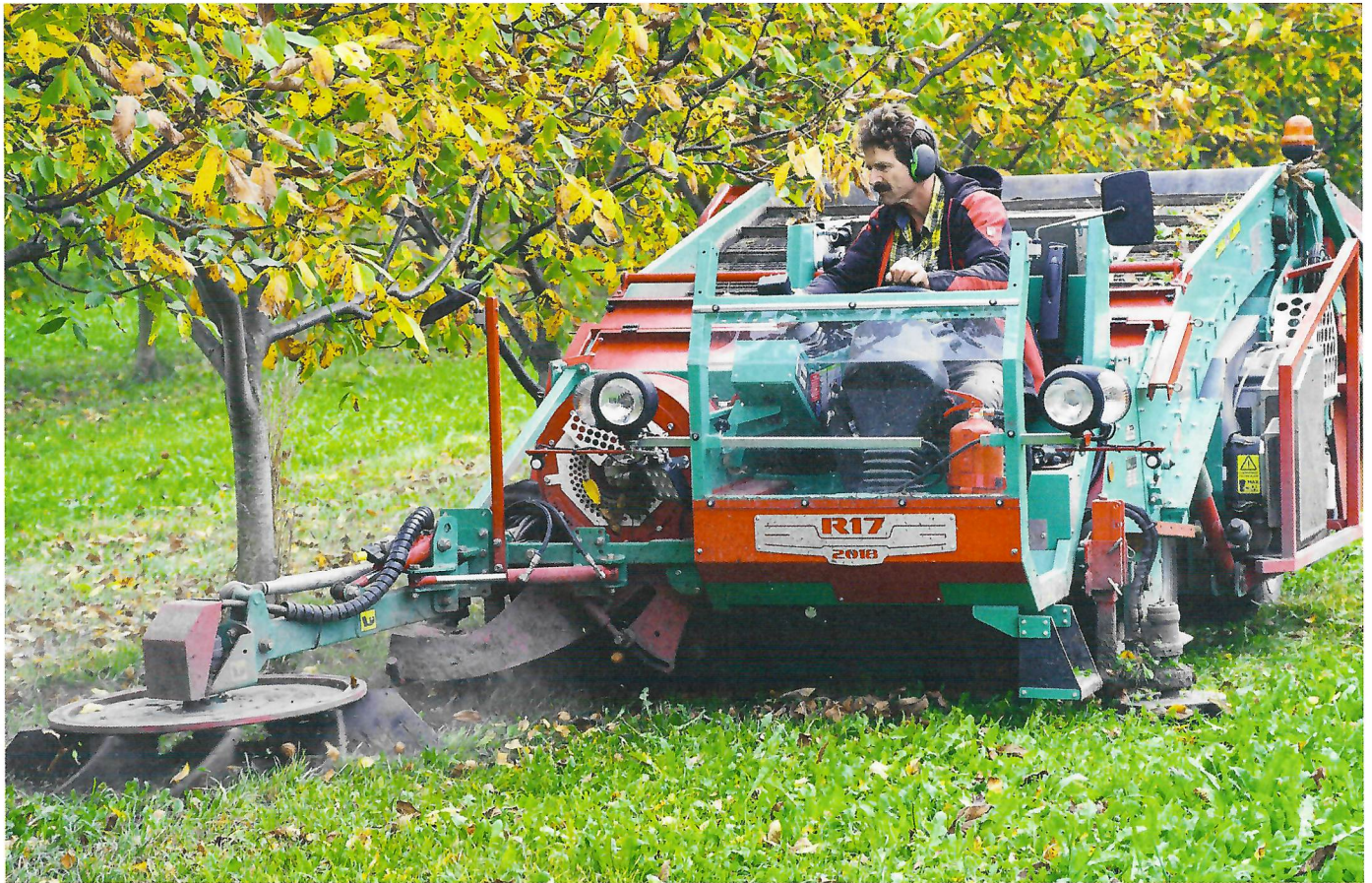
Johannes Janggen aus Malans GR bei der Nussernte mit dem Vollerter im vergangenen Oktober. Die Maschine ist speziell für die Ernte von Baumnüssen ausgestattet. Bilder: R. Hunger
