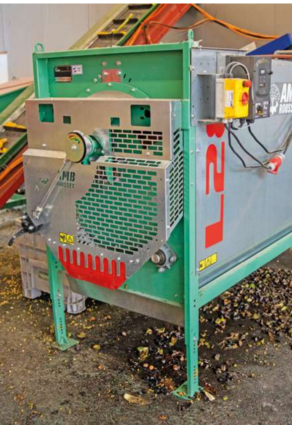
In der Waschtrommel werden die Walnüsse gesäubert, bis sie schön weiss sind.
