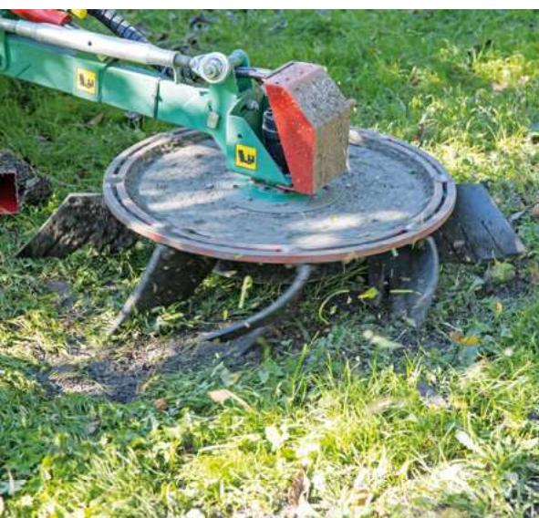
Drehende Kreisel mit Gummischaufeln und «Blasrohr» an der Erntemaschine.
