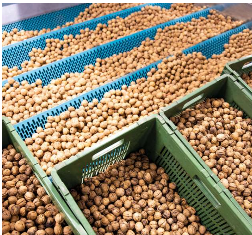
Zum Trocknen kommen die Walnüsse auf einen Rost, durch den Warmluft geblasen wird. Das Trocknen dauert drei Tage.
