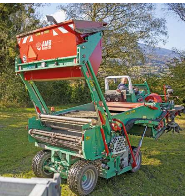
Der Nusscontainer der Erntemaschine wird hydraulisch gehoben ...
